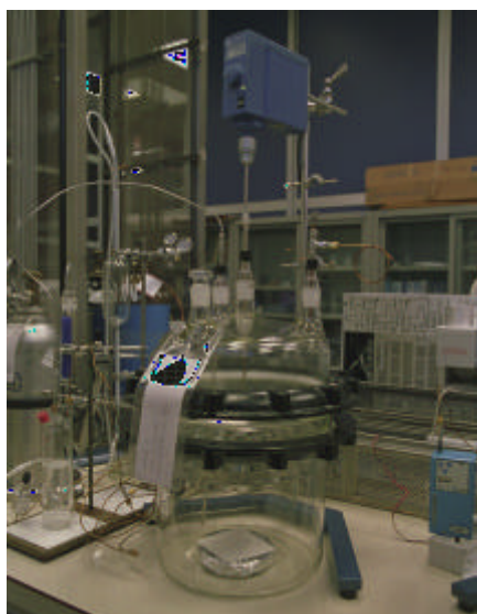
Camera ambientale di laboratorio per la misura delle emissioni di VOC.
