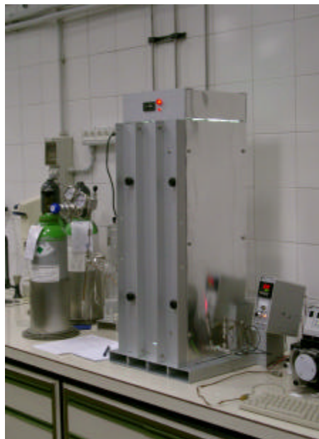
Sistema di misurazione dell'attività di degradazione fotocatalitica di BTEX di prodotti additivati con diossido di titanio.
