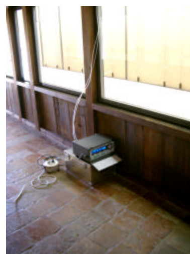
Misura del flusso di ricambio dell'aria interna in un espositore museale (Casa-Museo Fantoni di Rovetta - BG)
