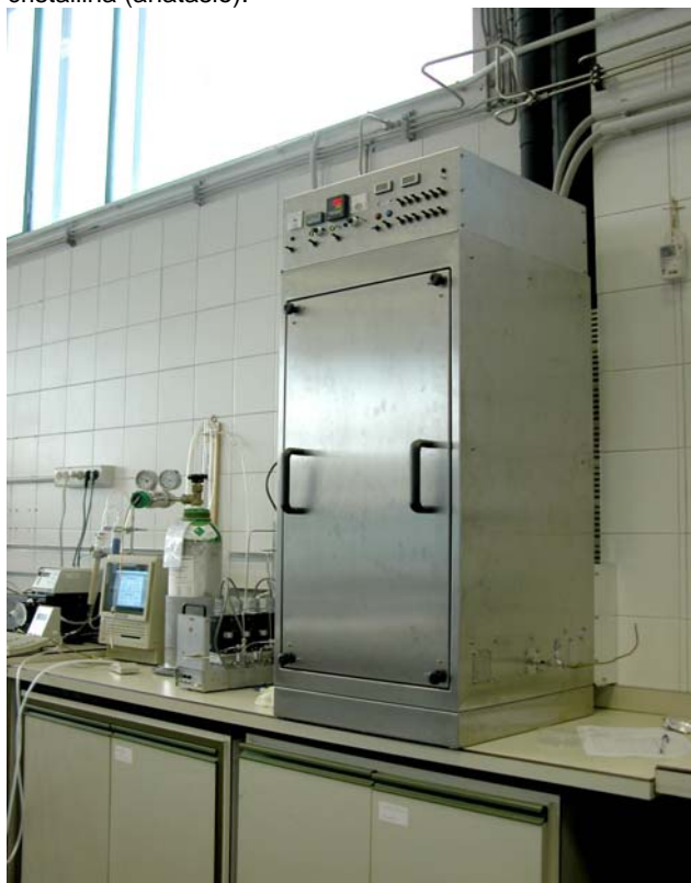
Sistema di misura avanzato realizzato nei laboratori ITC-CNR per la misura dell'attività di disinquinamento di composti organici aromatici (BTEX) da parte di materiali cementizi fotocatalitici.
