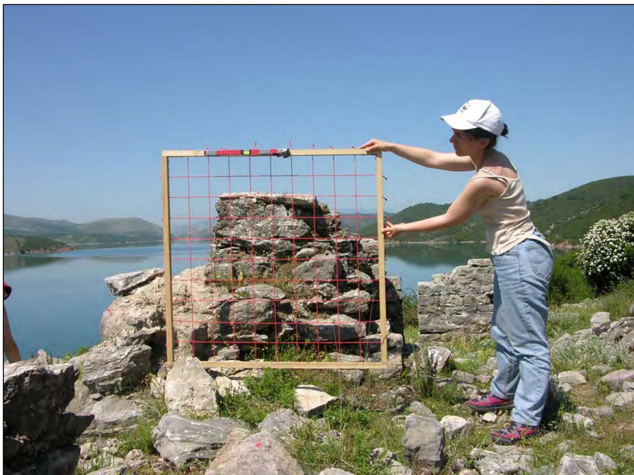
Fig. 14. La dima per il rilievo di una tessitura muraria.
