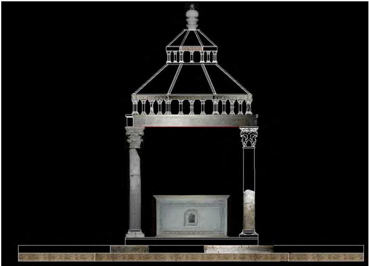
Fig. 9 - Prospetto del ciborio ottenuto mediante la sovrapposizione delle immagini raster dei frammenti al vettoriale.
