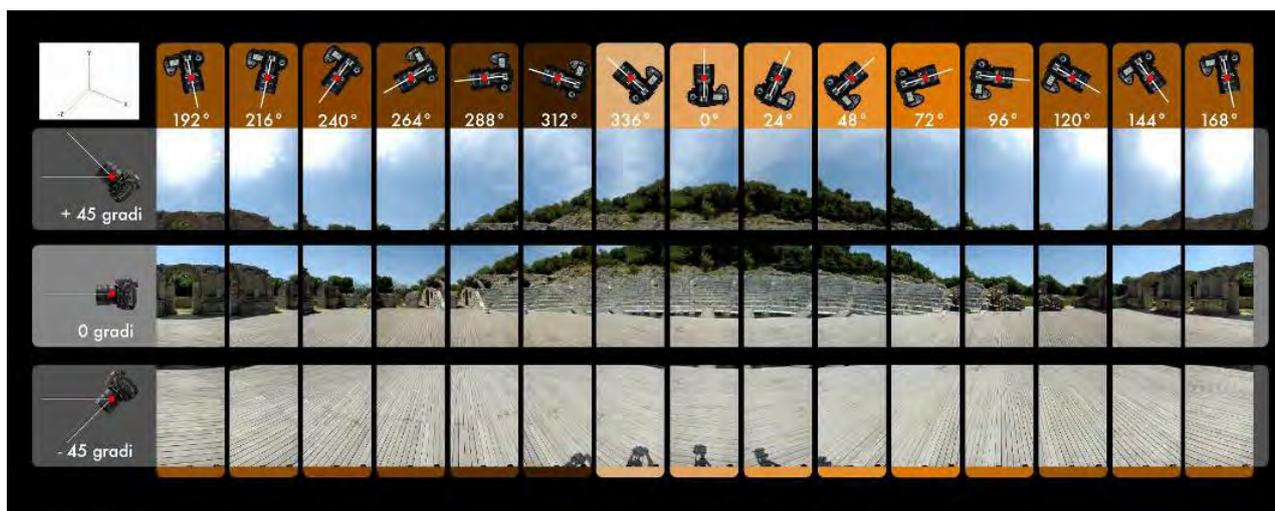
Fig. 9 – Sequenza di scatti per la realizzazione di foto immersive
